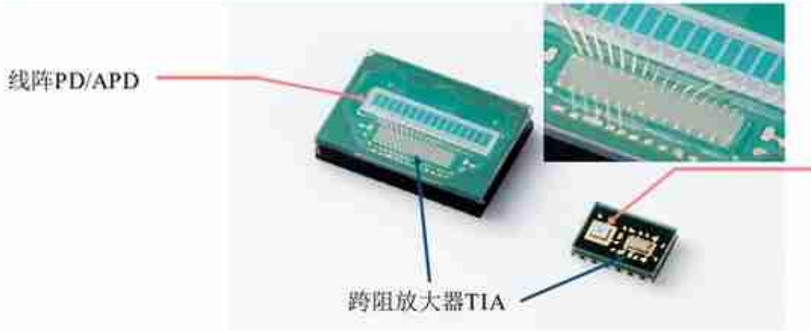
图表140： 日本滨松将 PD/APD 和 TIA 进行模块化集成
