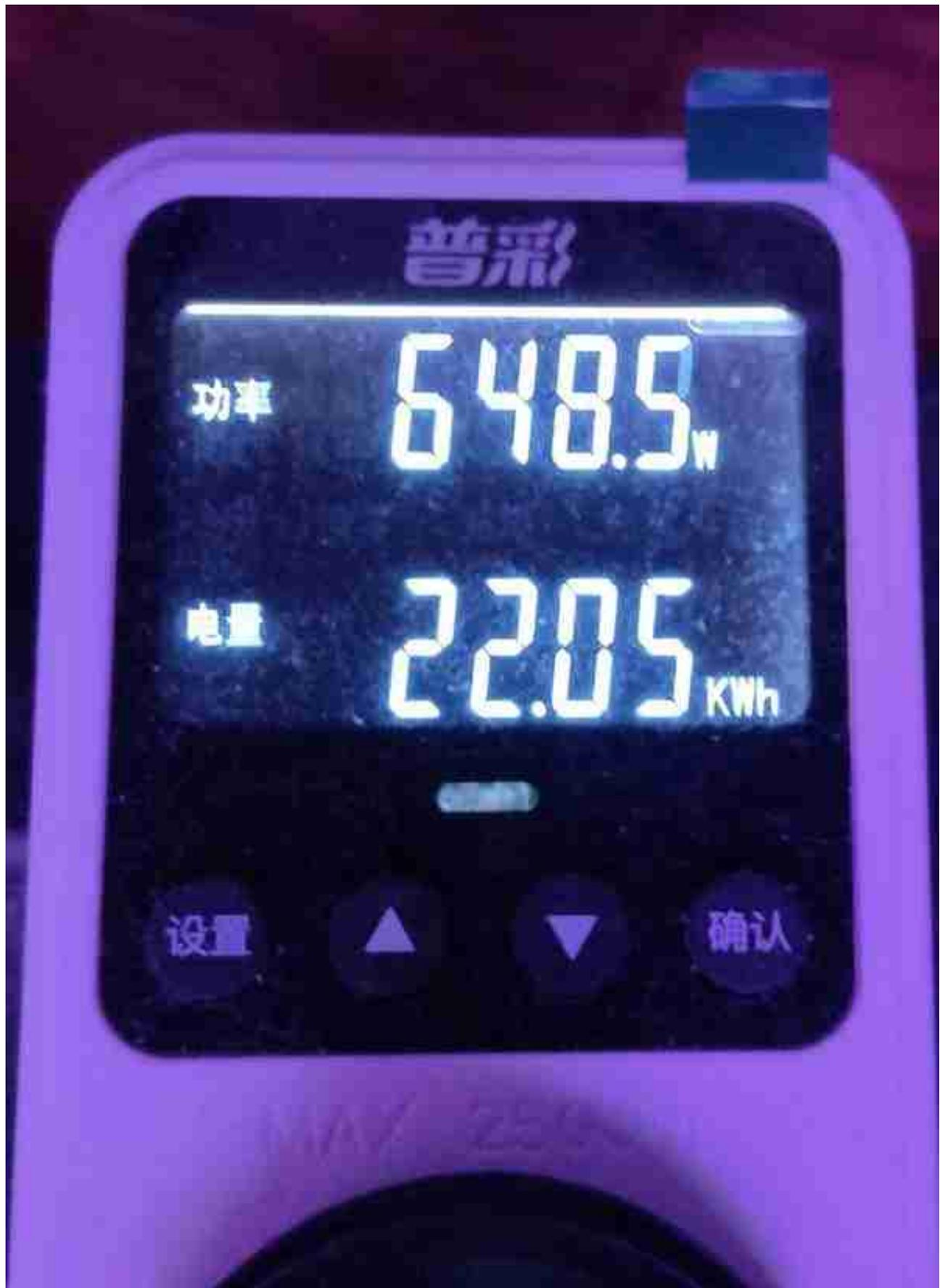
满载时CPU+GPU总功耗为483W，加上“稳定功耗”的85w X110%=94W，求得测试平台的实际消耗总功耗为577w。而功耗仪显示的实际输入功率为648w，
