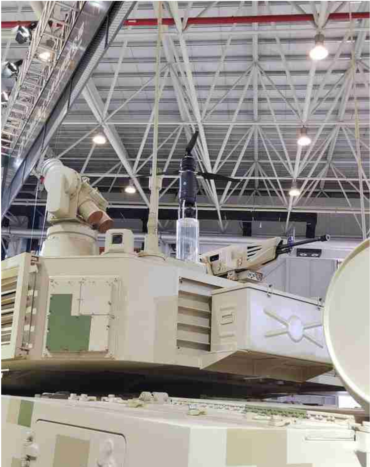
VT-4A1在炮塔尾篮里携带了类似QN506的旋翼无人机装置，可以用于提高其战场侦察能力
