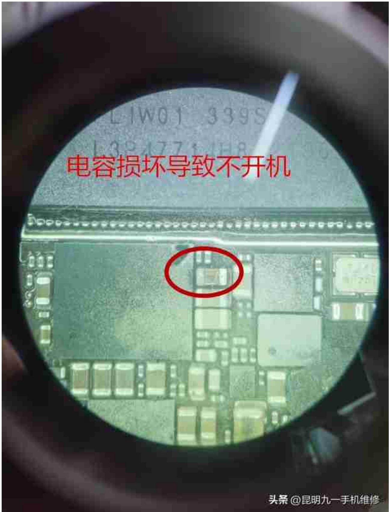
需要注意的是：现在的苹果手机采用的都是双层主板，维修主板对维修师傅的要求比较高，不专业的手机维修店一般是维修不了的，官方售后也是不维修的，对于正常使用突然不开机的手机一般都是可以维修好的，不需要更换整个主板，维修主板也不会影响手机里面的资料。维修主板最好去专业正规的手机维修店进行现场维修。
