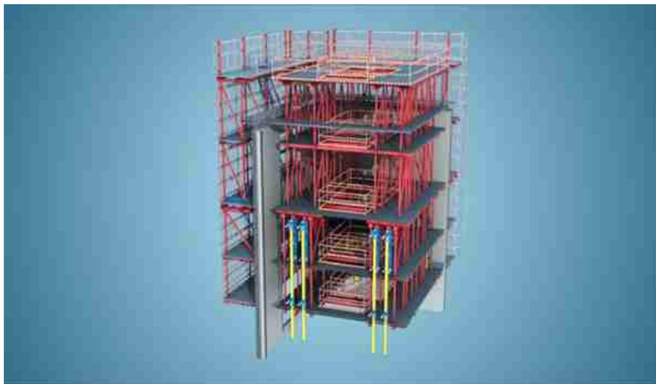
项目根据塔楼框架特点，核心筒采用“外爬内支”模架体系，外墙和井道采用液压爬模，内侧楼板采用盘扣架+木模支撑，核心筒墙体与水平楼板得以实现“筒-板”一体化施工，实现高效建造。
