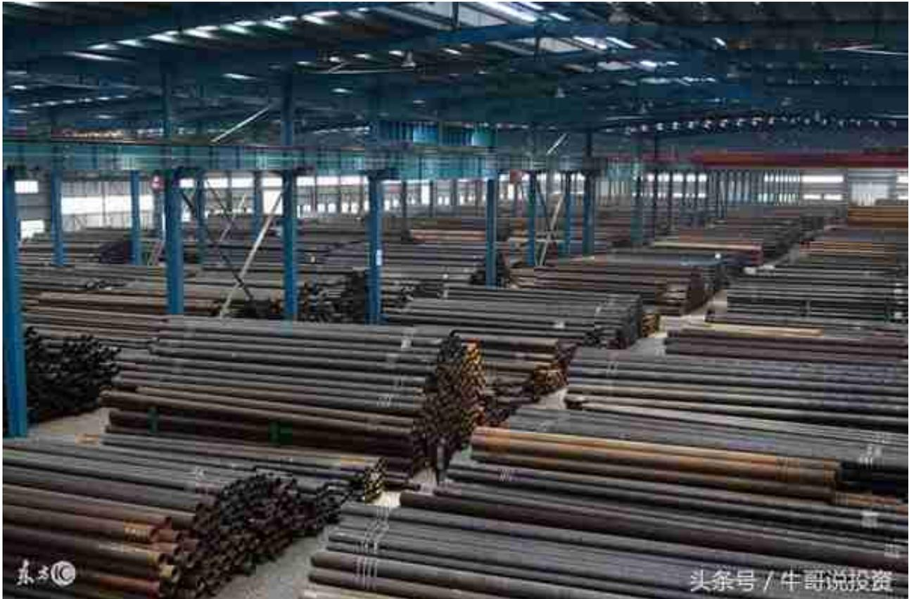
螺纹钢是热轧带肋钢筋的俗称。普通热轧钢筋其牌号由HRB和牌号的屈服点最小值构成。H、R、B分别为热轧 ( Hotrolled )、带肋 ( Ribbed )、钢筋 ( Bars ) 三个词的英文首位字母。
