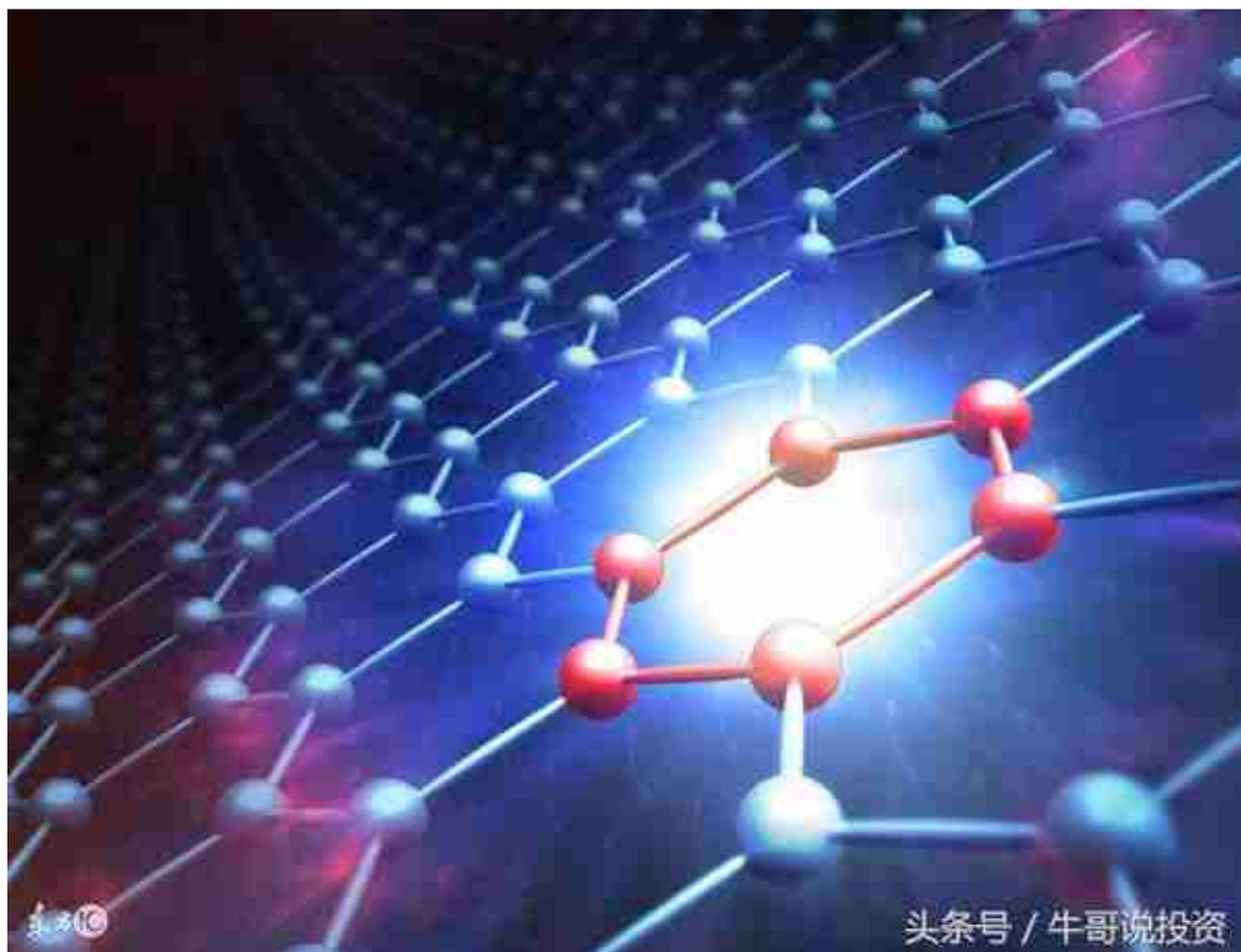
石墨烯 ( Graphene ) 是一种由碳原子以 $sp^2$ 杂化方式形成的蜂窝状平面薄膜，是一种只有一个原子层厚度的准二维材料，所以又叫做单原子层石墨。英国曼彻斯特大学物理学家安德烈·盖姆和康斯坦丁·诺沃肖洛夫，用微机械剥离法成功从石墨中分离出石墨烯，因此共同获得2010年诺贝尔物理学奖。石墨烯常见的粉体生产的方法为机械剥离法、氧化还原法、SiC外延生长法，薄膜生产方法为化学气相沉积法 ( CVD )。
