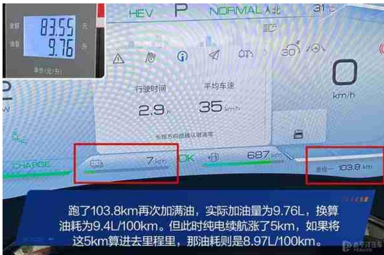
但毕竟这是唐DM-p是一辆插电混动车型，在跑馈电油耗测试的时候，混动系统给电池组充了一小部分的电量，纯电续航从2km变成了7km，如果把增加的5km纯电续航算到小计里程上，那油耗就是8.97L/100km。
