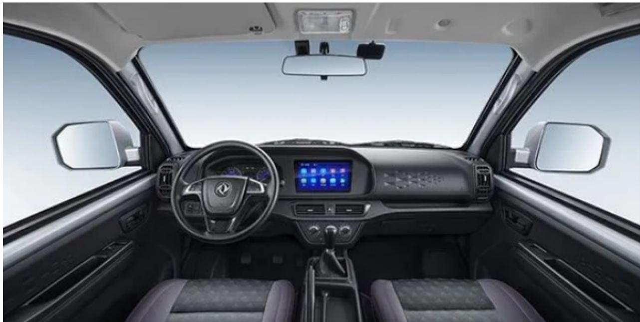
东风小康D71的驾驶室横向内宽度为1590mm，前纵向纵深960mm，前舱安全距离745mm，方向盘至座椅靠背的距离很宽，驾驶室内部的空间更大、整个座舱更加符合人机工程学，给用户带来非常好的驾乘舒适性。
