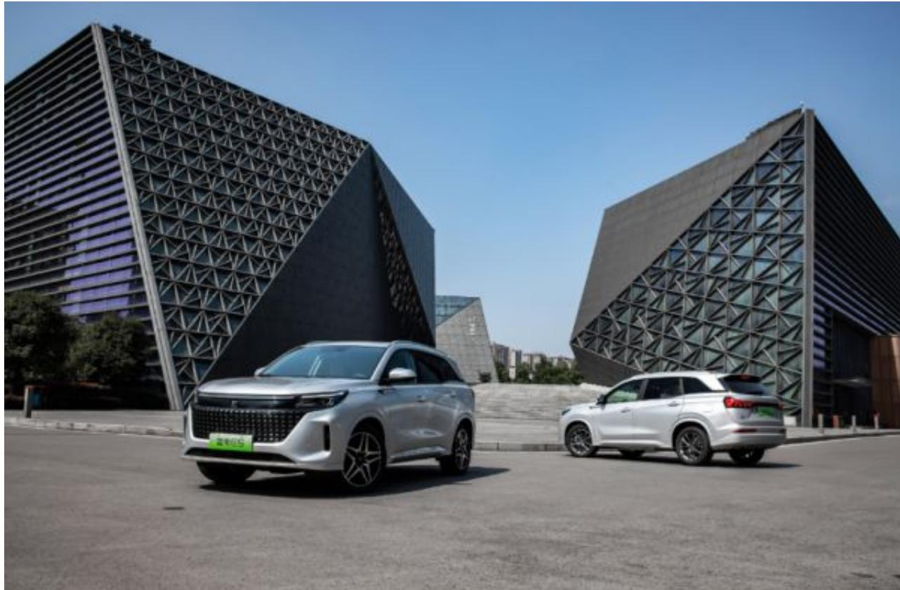
先来看看蓝电E5，它搭载了弗迪混动系统，由1.5L插混专用发动机和DHT300电混系统的，发动机和驱动电机分别有着81/130千瓦的最大功率，以及135/300牛·米的最大扭矩，0-50km/h的加速时间仅为2.91s，能够满足用户多场景下的用车需求，在超车、变道、转弯等常见驾驶场景下亦能做到游刃有余，动力响应和驾驶体验也都非常nice。
